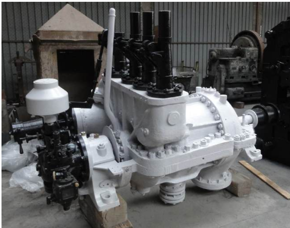
Obnovljena parna turbina v depolu tehniške dediščine (foto: Marko Mugerli, 2021).
